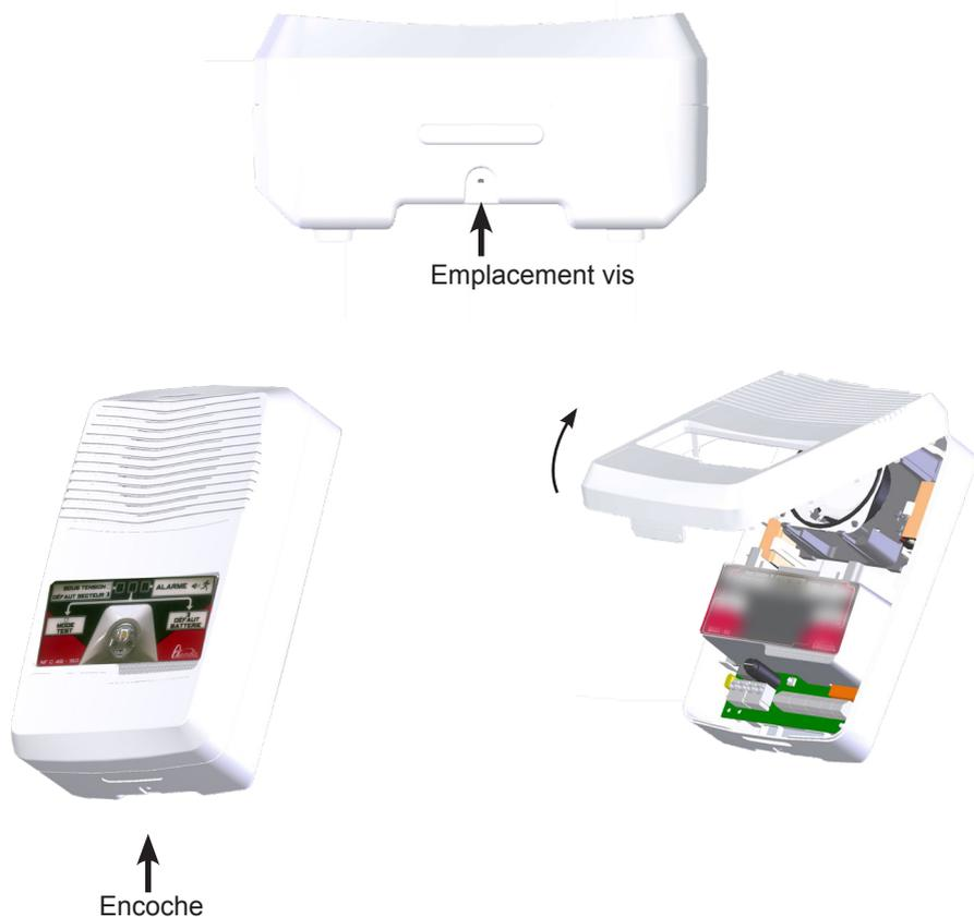
**⚠ Lors de la fermeture du boîtier, ne pas oublier de remettre la vis.**
